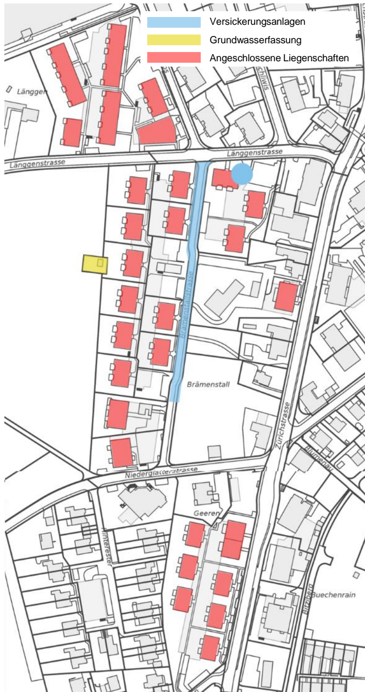
Abbildung 2: Nahwärmeverbund mit Grundwassernutzung
